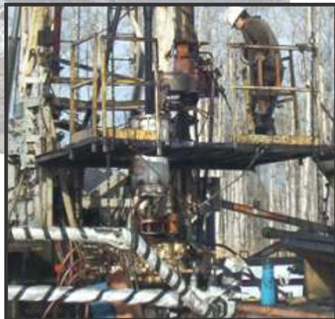
Los tubos pueden ser pasados a través del escaneador ScanNex<sup>®</sup> ya sea al salir o al entrar al pozo.
